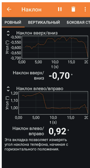
Рис. 17. Визначення кутів нахилу смартфону в застосунку Phyphox
