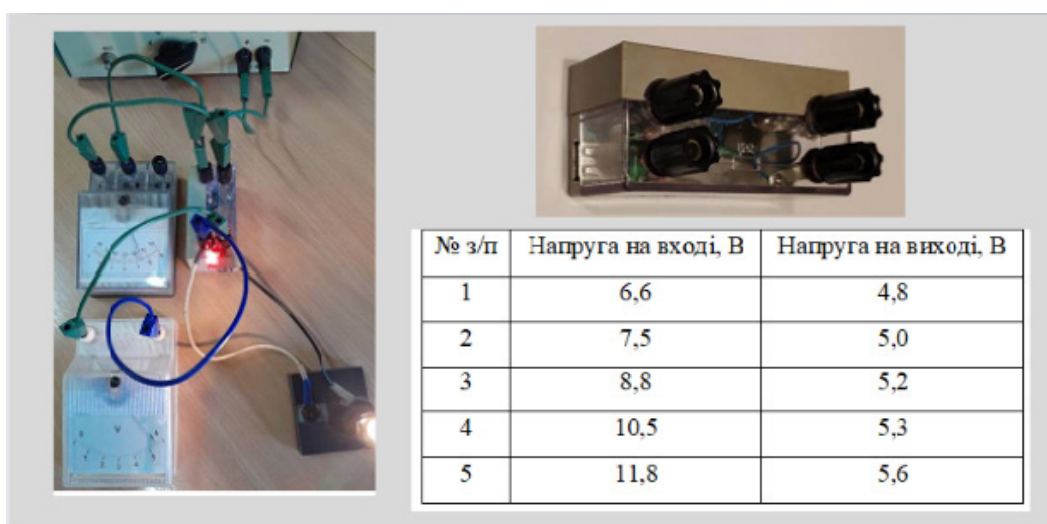
Рис. 3. Дослідження блока регулювання і стабілізації напруги
